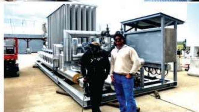
LNG Vaporiser Skid
